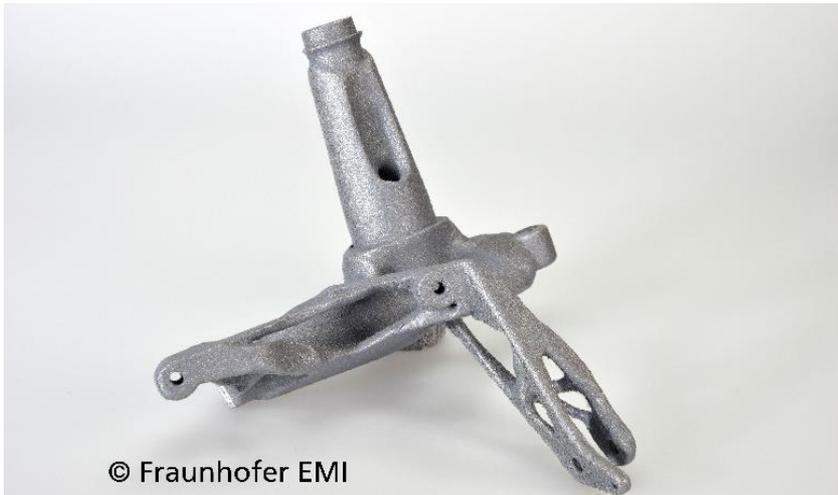
Radträger mit Parametern des Maschinenhersteller gefertigt.
